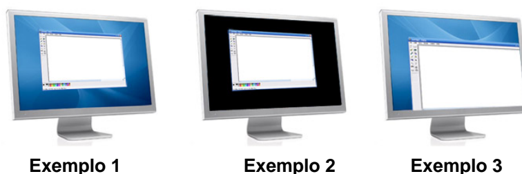
Figura 3: Aplicação de resolução fixa executada em resolução de telas diferentes
